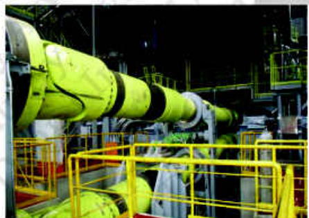
■ مهندسی معکوس و ساخت کوپلینگ نورد گرم Reverse Engineering and Manufacture of Hot-rolled Coupling
